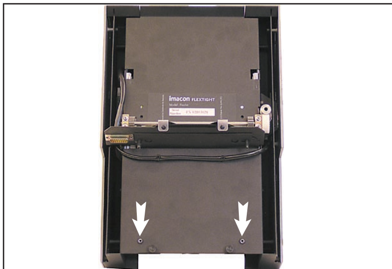
Figura 11: Orificios para insertar los tornillos de envío en la parte posterior del alimentador
