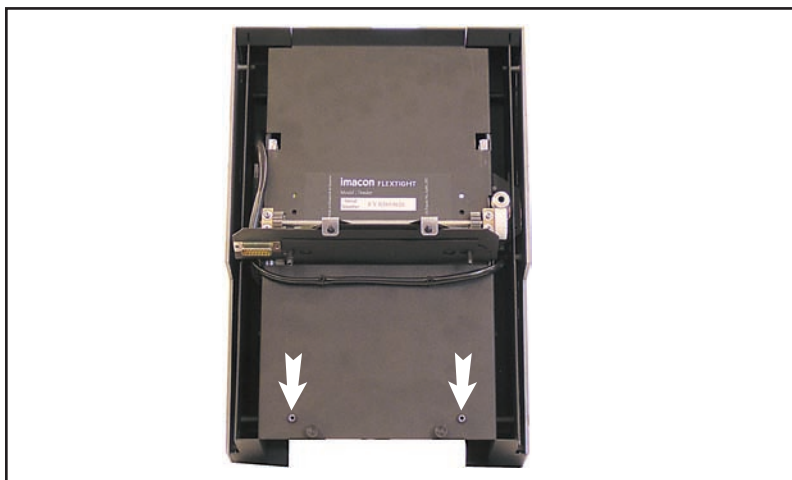
Figure 2 : Emplacements des vis d'expédition sur le panneau arrière de l'alimentateur
